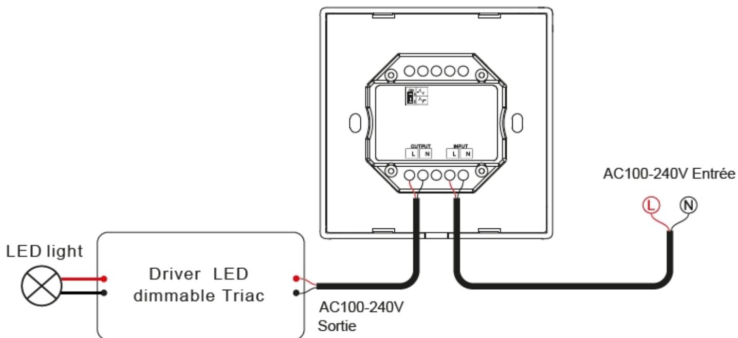
Remarque : Lors du calcul du nombre maximum de lampes ou de drivers, les paramètres de puissance d'entrée ou de courant d'entrée d'une seule lampe ou driver doivent être utilisés, les paramètres de puissance de sortie ne peuvent pas être utilisés, sinon le produit sera surchargé et endommagé.
