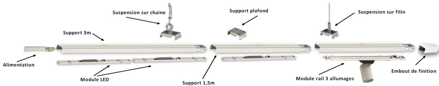
Votre ligne continue est composée d'une alimentation, de plusieurs supports 1,5 mètres ou 3 mètres, de plusieurs modules LED (1,5m) qui viennent s'enficher dans les supports (1,5 et 3 m), éventuellement d'un ou plusieurs modules pour rail 3 allumages (longueur 1,5 mètres, projecteurs vendus séparément) et d'un embout de finition. Cette structure pourra être
