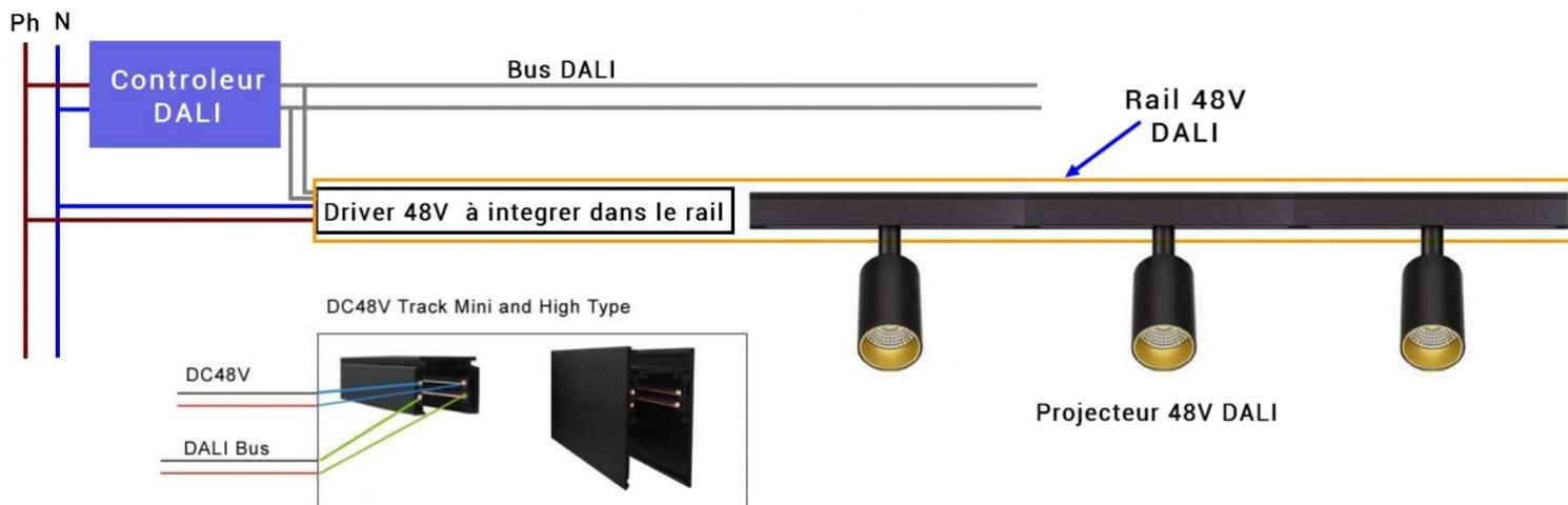
**Attention ce n'est pas un driver DALI ( il n'est pas dimmable, ce sont les projecteurs avec driver 48V DALI qui sont dimmables) , il permet de raccorder le bus DALI et d'acheminer les données aux projecteurs, installés sur le rail.**
