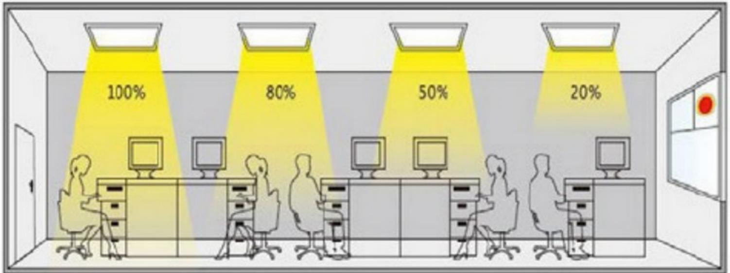
Une luminosité qui s'ajuste automatiquement en fonction des différents paramètres exposés plus haut serait donc une solution idéale pour que l'ensemble du bureau soient correctement éclairé tout au long de la journée, tout en diminuant la facture énergétique.
