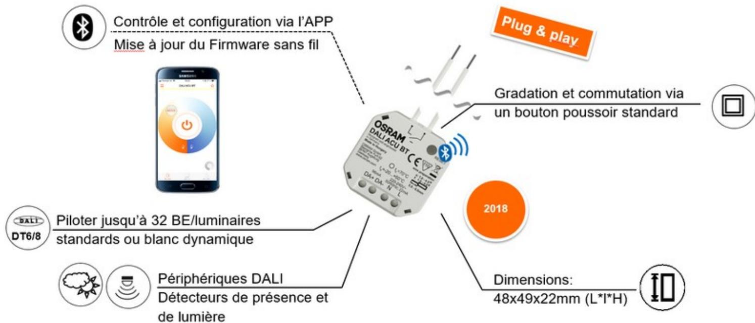
Ce petit contrôleur prend en charge jusqu'à 32 drivers DALI qui pourront être affectés à 4 groupes de commande distincts, il gère également 4 coupleurs de bouton poussoir et détecteurs de luminosité et mouvement DALI.
