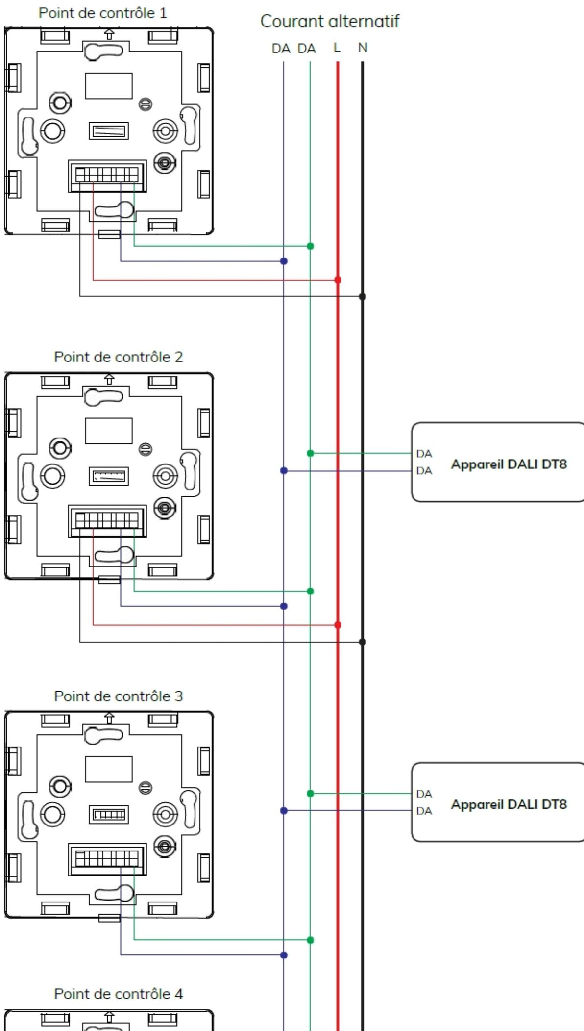
**2 panneaux DALI maximum peuvent être connectés au secteur dans le même circuit de commande**
